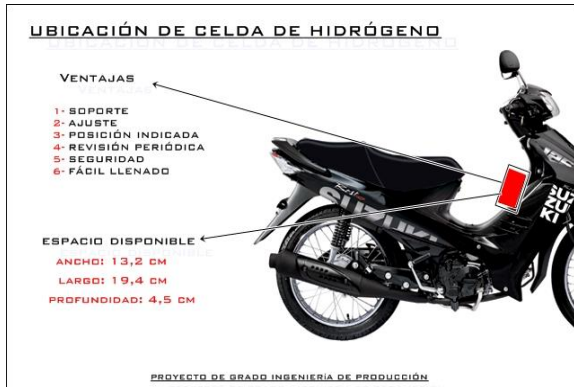
Figura 1. Ubicación de la celda de hidrógeno en la motocicleta.
